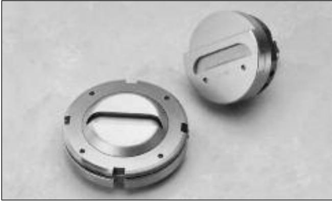
Das Kiemenwerkzeug von Wilson Tool hat eine gefederte, selbstabstreifende Matrize. Das gewährleistet einen problemlosen Arbeitsablauf und eine einfache Programmierung. Durch auswechselbare Schneid- und Prägeeinsätze können Sie mit geringem Kosten- und Arbeitsaufwand ganz leicht auch Lüftungsschlitze mit unterschiedlichen Dimensionen herstellen.
